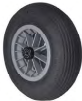
ROUE GONFLEE 4 PLIS AVEC ROULEMENT A BILLES DE 16 MM 4.80/4.00-8
