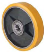
ROUE JANTE FONTE BANDAGE POLYURETHANE MOYEU DE 45 MM RB25
