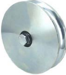
GALET A 2 ROULEMENTS A GORGE RONDE DE 20 MM RB20 M16
