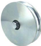
GALET A 2 ROULEMENTS A GORGE RONDE DE 25 MM RB20 M18
